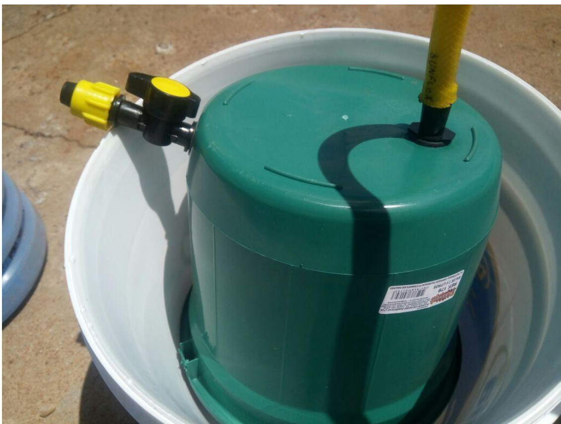
Figura 4 -- Modelo de armazenador e medidor de biogás.
