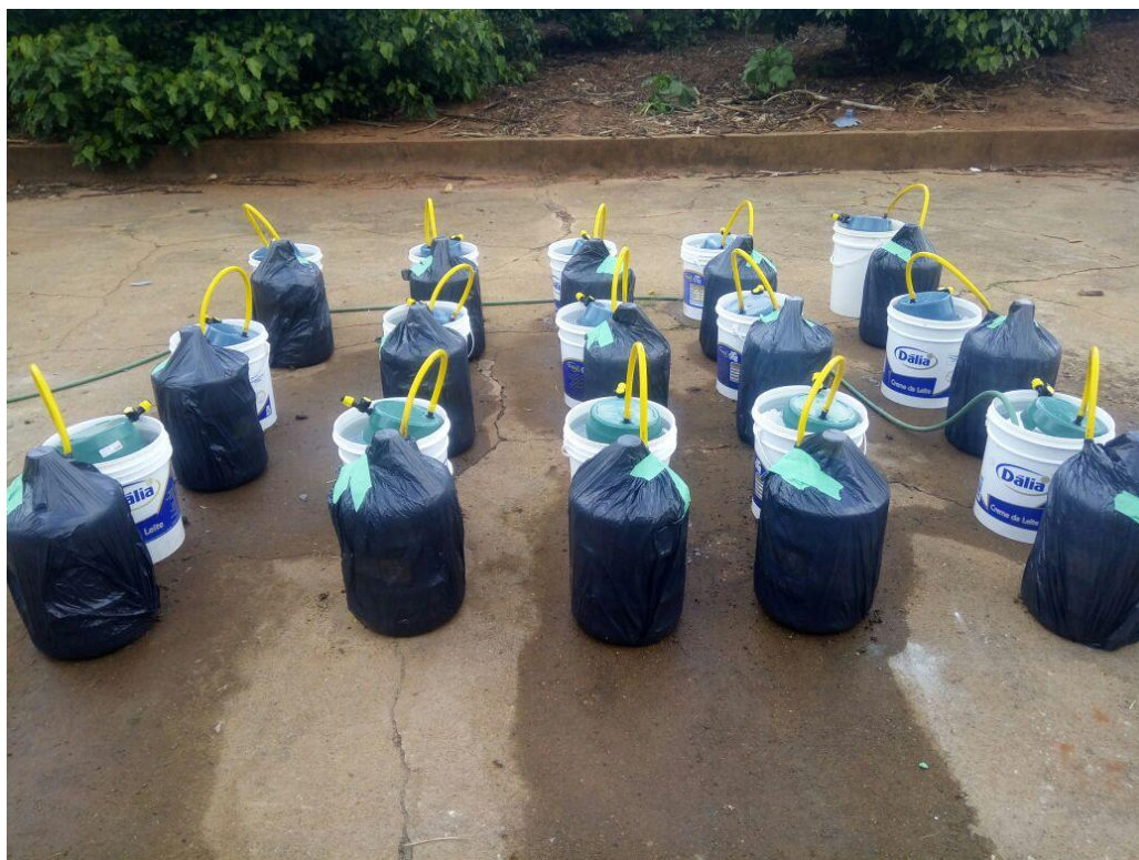
Figura 2 - Revestimento externo para evitar a entrada de luz.
