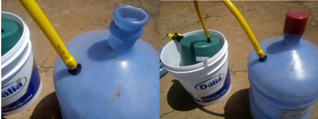
Figura 1 - Sistema de transporte do Biogás para o armazenador
