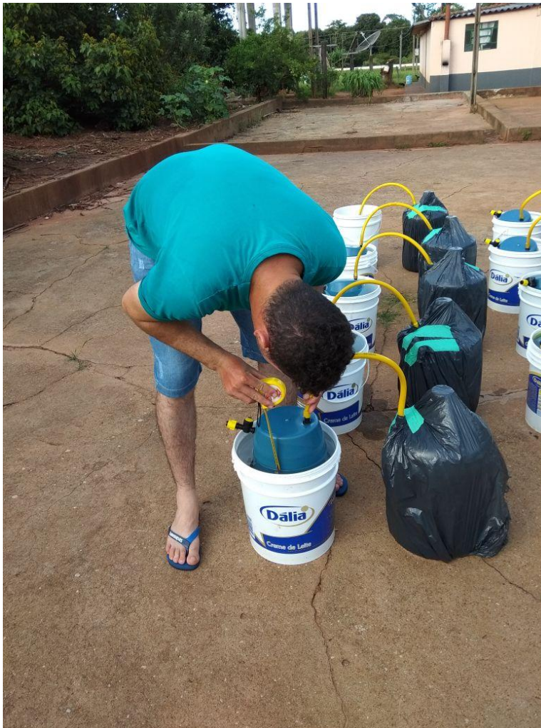
Figura 5 - Medição do volume produzido e armazenado.
