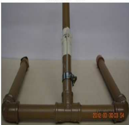
Fig. 16. Base com as 4 abraçadeiras de nylon presas com a abraçadeira de metal.
