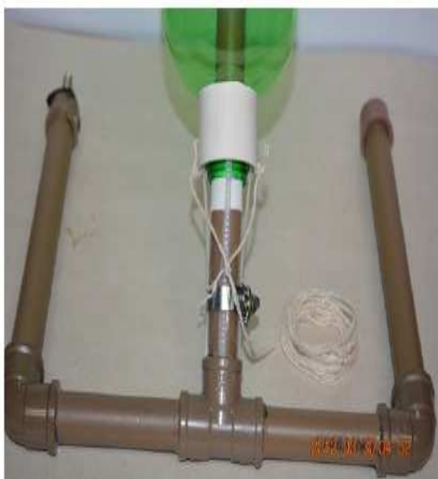
Fig. 19. Base com anel branco posicionado sobre as 4 "cabeças" de nylon.
