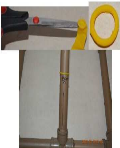
Fig. 13. Colocação do anel do balão a 8 cm acima do "te".
