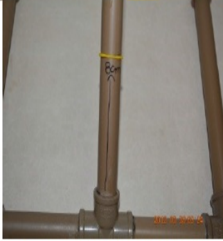
Fig. 13. Colocação do anel do balão a 8 cm acima do "te".
