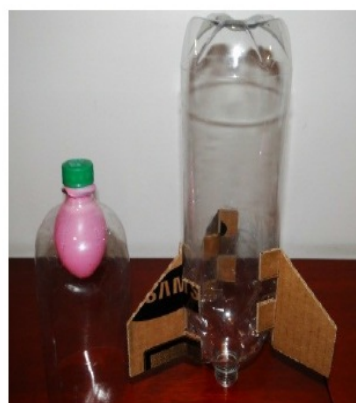
Fig. 5. Bico e foguete com aletas presas.
