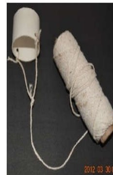
Fig. 18. Gatilho de liberação do foguete.
