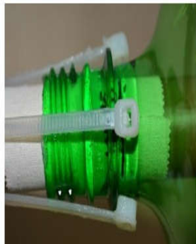
Fig. 17. Posição das cabeças das abraçadeiras sobre o anel sustentação.
