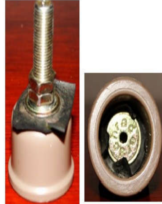
Fig. 9. Detalhes da válvula de pneu de bicicleta preso no "cap".
