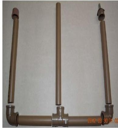
Fig. 8. Disposição em que serão montados os canos nas conexões.
