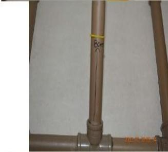
Fig. 13. Colocação do anel do balão a 8 cm acima do "te".
